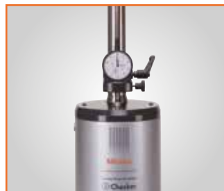
Kalibrierung unter Verwendung einer analogen Messuhr
