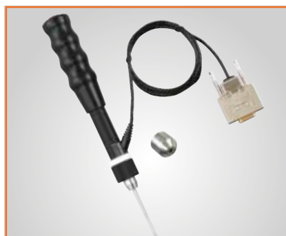
HLDL Schlaggerät UD-413 Für konkave Werkstücke, wie Verzahnungen, Kugellager usw.
