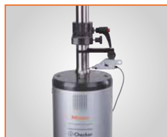
Mit Fühlhebel (induktivem Taster) überprüfen
