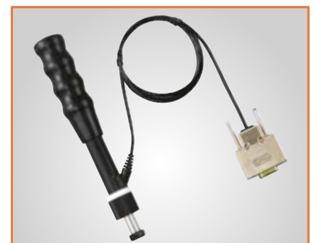
HLD + 15 Schlaggerät UD-414 Für Verzahnungen, verschweißte Ecken usw.
