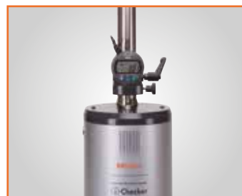
Kalibrierung unter Verwendung einer digitalen Messuhr
