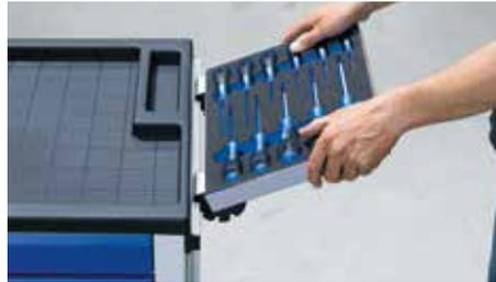
Mit nur einem Klick fixieren Sie das Einhänge-Profil an der Schiene.
